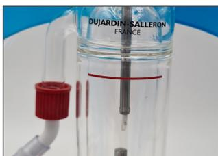
» Remplissage de la chaudière jusqu'au trait et allumage du chauffage
